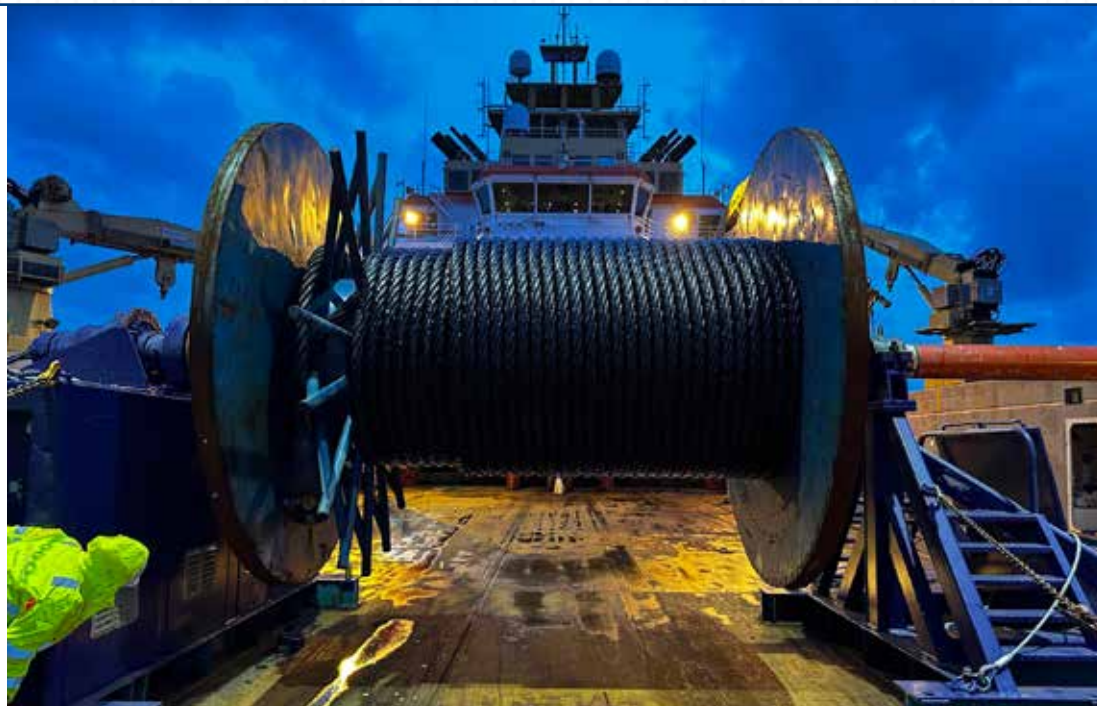
De 90 mm sleepkabel van het 300 ton spoelapparaat vervangen.
